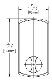
Door Prep: Cross Bore 2 1/8", Edge Bore 1", Latch Face 1" x 2 1/4"
